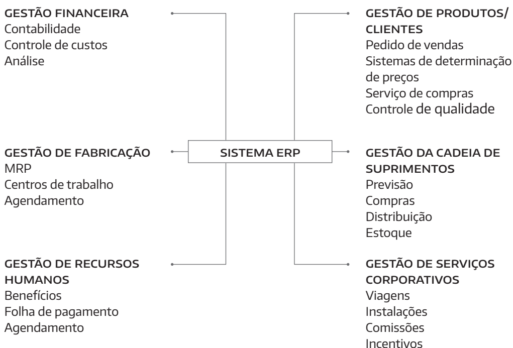
Figura 3. Principais módulos de um sistema ERP e algumas de suas funções gerais.
