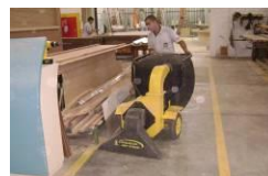
Figura 13- Aspirador Industrial, design apropriado que facilita a execução do senso de limpeza
